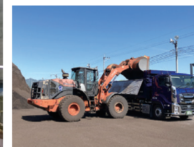
バイオマス燃料積込作業
